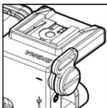
Die von der Kamera entfernten Riemenhalter können an den Riemenhalterbuchsen der HU-11 angebracht werden.
