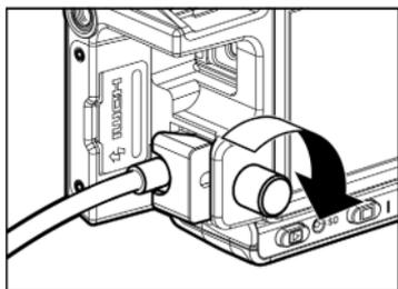
Die HU-11 ist mit einer HDMI-Kabelverriegelung versehen, die verhindert, dass sich das HDMI-Kabel beim Aufnehmen löst.
