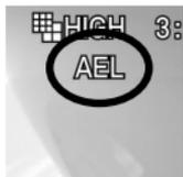
Die **AEL**-Taste ist verfügbar für Aufnahmen mit festgelegter Belichtung im Automatikmodus.
