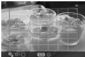
Der Entfernungsmessbereich kann durch Drücken der AEL-Taste und Drehen des vorderen/hinteren Einstellrads geändert werden (die Größe des Rahmens für den Mehrpunktentfernungsmessbereich ändert sich).
