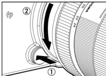
Drücken Sie zum Entfernen des Objektivs die Objektivverriegelungstaste und drehen Sie das Objektiv so weit wie möglich gegen den Uhrzeigersinn. Nehmen Sie das Objektiv vorsichtig vom Kameragehäuse.
