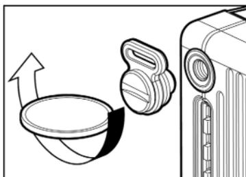
Bringen Sie die mitgelieferten Riemenhalter mithilfe einer Münze fest an den Stativ-/Riemenhalterbuchsen auf beiden Seiten der Kamera an.
