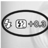
Nach Abschluss der Einstellung werden das Einstellungssymbol und der Korrekturwert angezeigt.
