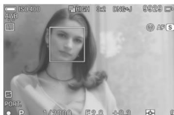
Werden ein Gesicht und ein Auge erkannt, erscheint der orangefarbene Erkennungsrahmen. Wenn das erkannte Gesicht und Auge nach dem Drücken des Auslösers bis zum ersten Anschlag fokussiert werden, wechselt der Erkennungsrahmen zu Grün.
