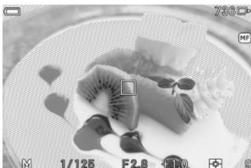
Möglicherweise überbelichtete Teile werden mit Zebra-Muster angezeigt.
