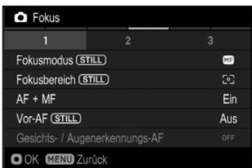
Die sekundären Elemente können weiter in Seiten unterteilt sein. Verwenden Sie die Tasten **<** **>** oder das vordere Einstellrad, um zu einer anderen Registerkarte zu gelangen. Drücken Sie die Taste **MENU** zum Verlassen der Registerkarte.
