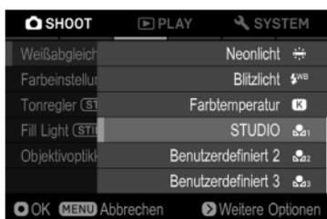
Einem benutzerdefinierten Weißabgleich kann eine Anmerkung hinzugefügt werden. Die Anmerkung wird im Submenü „Weißabgleich“ dargestellt. Das ist nützlich, wenn die Verwendung eines zuvor registrierten benutzerdefinierten Wechselobjektivs nötig ist.
