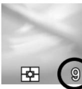
Die Zahl unten rechts im LCD-Monitor gibt an, wie viel Puffer noch übrig ist. Dies ist die maximale Anzahl von Frames für die fortlaufende Aufnahme. (Bei Überschreitung von neun Frames erhöht sich die Anzeige für die maximale Anzahl von Frames für die fortlaufende Aufnahme nicht weiter) Bei Anzeige der Zahl „0“ ist keine weitere Aufnahme möglich.
