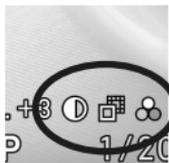
Das Symbol des derzeit angepassten Parameters wird neben dem Farbmodussymbol angezeigt.
