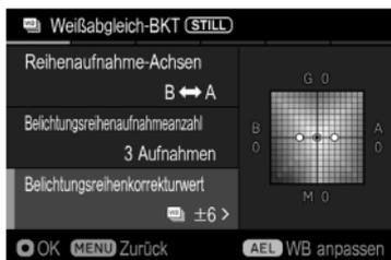
In einer einzelnen Aufnahme können mehrere Bilder mit unterschiedlichem Weißabgleich aufgezeichnet werden.
