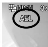
AEL 按键可用于在自动模式下使用指定的曝光进行拍摄。
