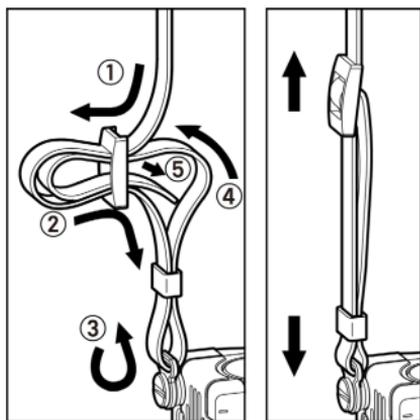
如图所示，松开随附肩带的两端并将其连接到左右两侧的肩带固定环上。
