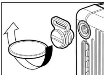
使用硬币将附带的肩带固定环牢固地安装到相机两侧的三脚架/肩带固定环插口上。
