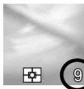
液晶显示屏右下角的数字表示缓冲区的剩余量。这也是连拍的最大张数。(如果连拍的最大张数超过了 9 张，显示也不会变化)当数字变为“0”时，快门将无法释放。
