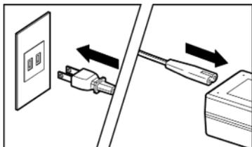
您可以使用交流电源适配器套件 SAC-7P(另售)从墙壁插座为相机供电。
