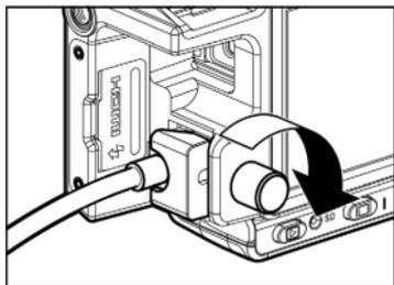
HU-11 配有 HDMI 连接线锁定装置，可防止 HDMI 连接线在拍摄图像时断开连接。
