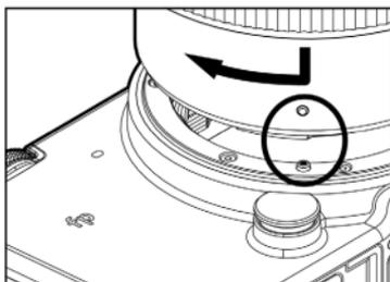
**3** 将相机上的镜头卡口标记与镜头上的标记对齐。将镜头插入相机卡口并顺时针旋转镜头，直至其卡入锁定位置。
