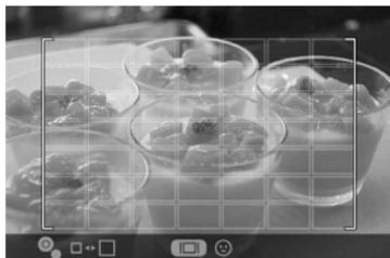
Il est possible de modifier l'étendue de la zone de mesure de distance en appuyant sur le bouton **AEL** et en tournant la molette avant/arrière (ce qui modifie la taille du cadre de la zone de mesure de distance multipoints).
