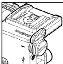
Les fixations de courroie détachées de l'appareil photo peuvent être attachées sur les pas de vis pour fixation de courroie de l'unité HU-11.
